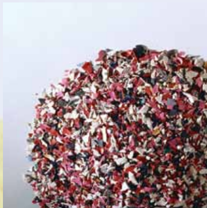
Plastični odpad predelan v kosmiče.
